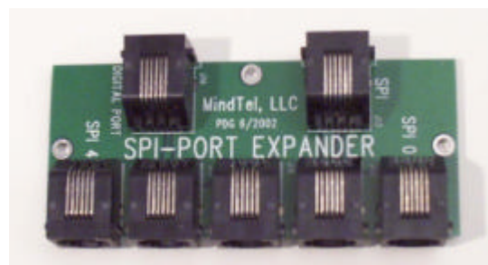
Fig. 4. SPI Port Expander.
